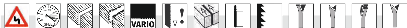
Testera oštrica za zakrivljena posekotine Brzo sečenje Čist rez Grub rez Raznoliko zubalo Obrnuti zubi Pravo rezati Dužina rezanja Zubi po inču/zubi udaljenost u mm Side set zubanje - grubi rezovi Konično tlo oštrica, zubi dijagon., izoštrjen zubalo - precizno, čisti rezovi Talasasta garnitura zubalo - fino i čist posekotine Bočni set, dijagonalno izoštrjen zubanje - grubo, brzo posekotine
